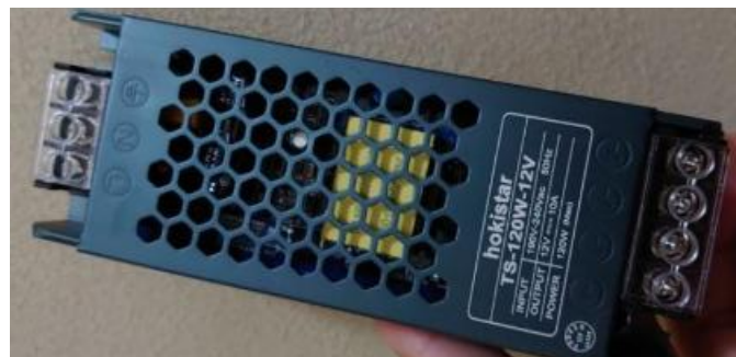
Gambar 2. 11 Power supply DC 12V 10A untuk supplai ke sistem kontrol
