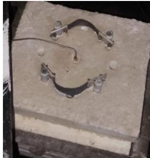
Gambar 2. 21 Alumunium Oksida untuk Reflektor Panas pada Ruang Bakar
