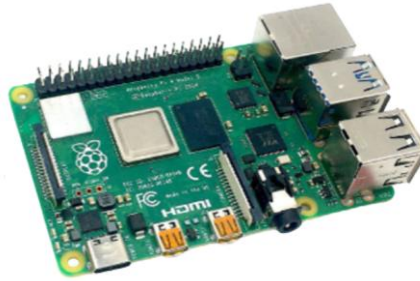
Gambar 2. 4. Raspberry pi 4B[23]
