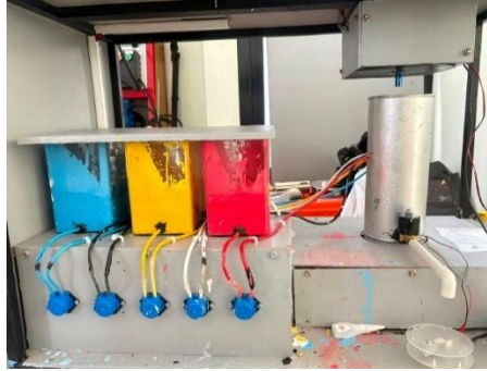
Gambar 4. 26. Setup Pengujian Gravimetric pada Pompa Peristaltik (Dokumentasi peneliti)
