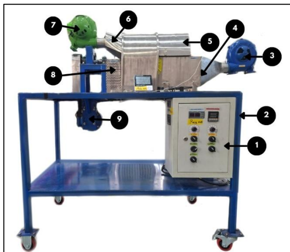
Gambar 4.1 Hasil fabrikasi test bed dehumidifier
