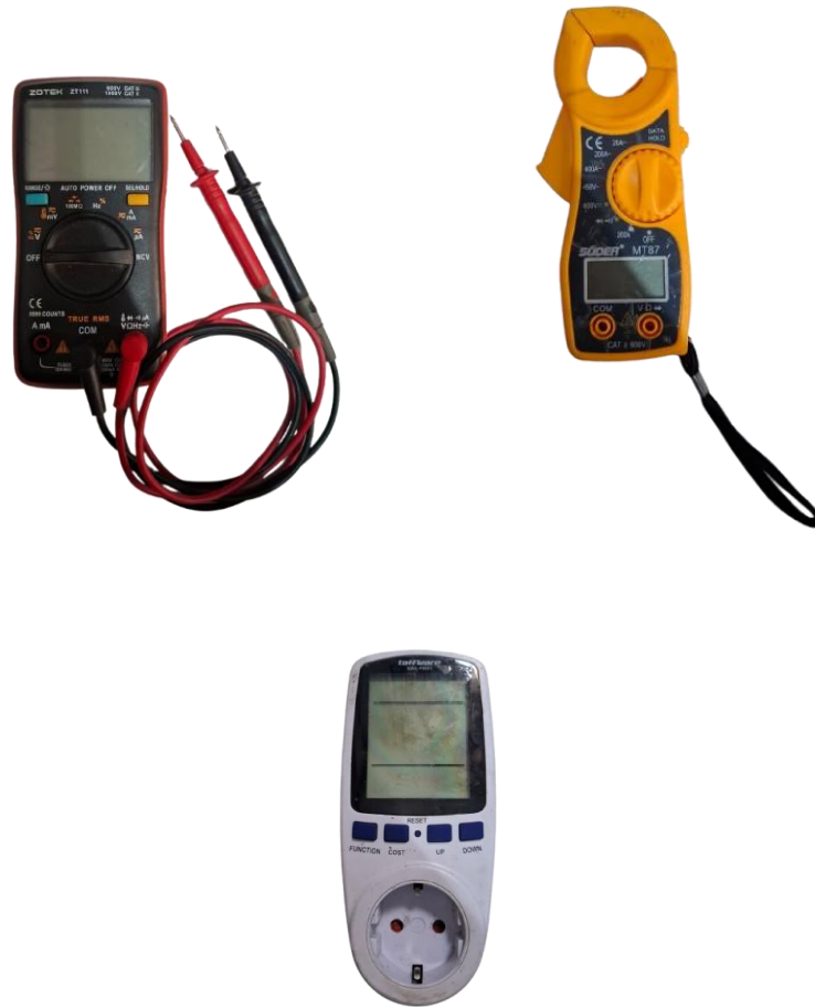
Gambar 4. 3 Multimeter, clampmeter dan display listrik
