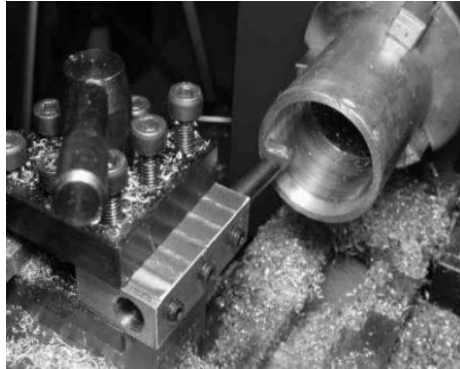
Gambar Pembubutan lubang poros
