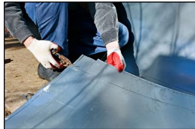
Gambar Pemotongan plat
