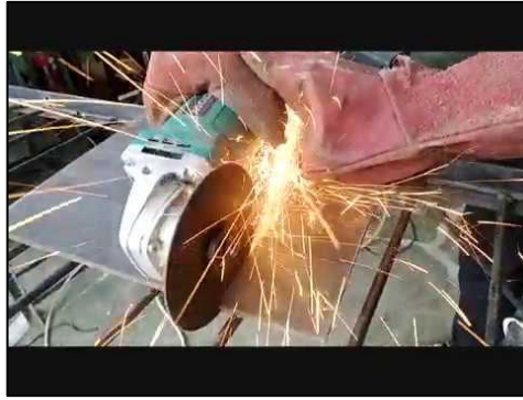
Gambar Pemotongan pelat
