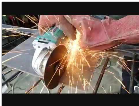
Gambar Pemotongan pelat
