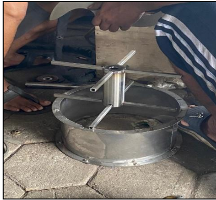
Gambar Fabrikasi dan assembly rangka rotary wheel
