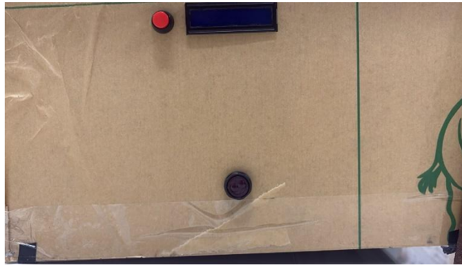
Gambar 4.20. Pemasangan Sensor Proximity pada Robot
