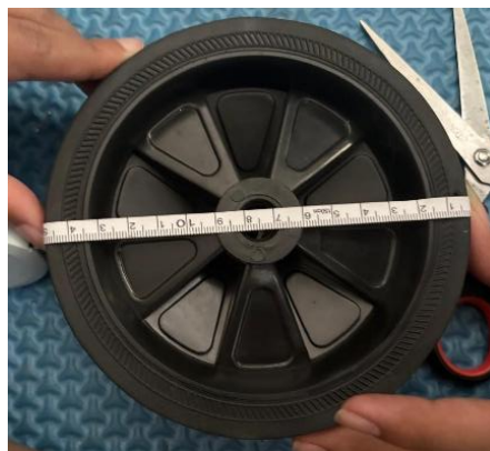
Gambar 4.9. Pengukuran Diameter Roda Robot
