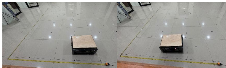
Gambar 4.13. Pengukuran Jarak Perpindahan Robot Menggunakan Meteran
