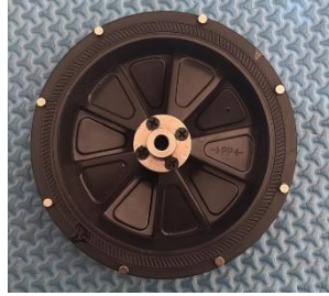
Gambar 4.11. Konfigurasi Magnet pada Roda Robot
