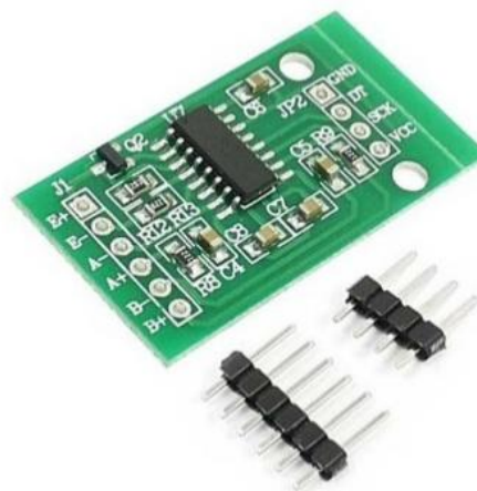
Gambar 2. 13 Modul ADC HX711
