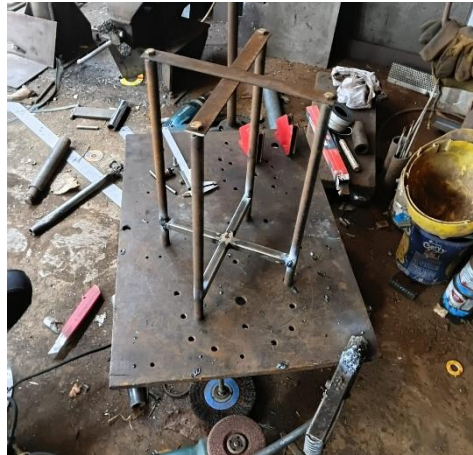
Gambar 4-8 Proses Pembuatan Dudukan Tangki
