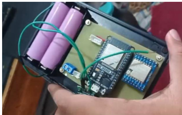
Gambar 4-6 Pemasangan PCB pada Box
