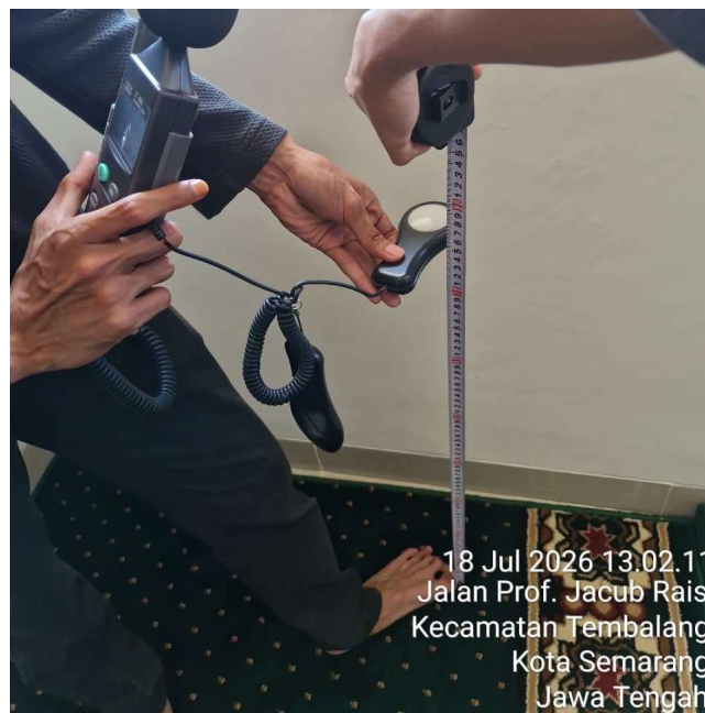
Gambar 4. 2 Pengukuran Tinggi Bidang Ukur
