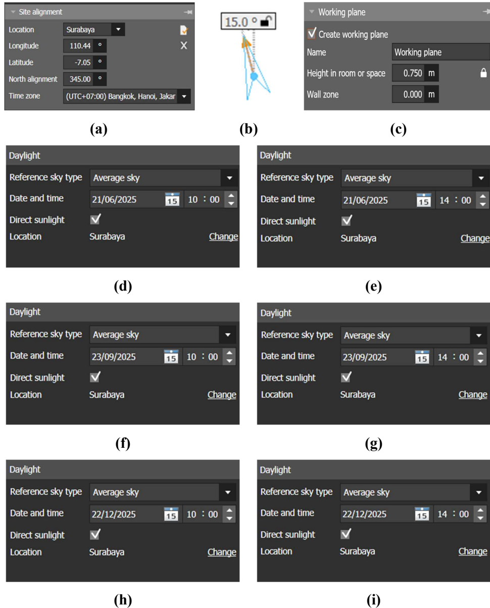
Gambar 4.102 Parameter Simulasi DIALux pada Rekomendasi Desain 2 (a) Lokasi; (b) Arah Mata Angin; (c) Bidang Ukur (d) 21 Juni, 10.00 WIB; (e) 21 Juni, 14.00 WIB; (f) 23 September, 10.00 WIB; (g) 23 September, 14.00 WIB; (h) 22 Desember, 10.00 WIB; (i) 22 Desember, 14.00 WIB
