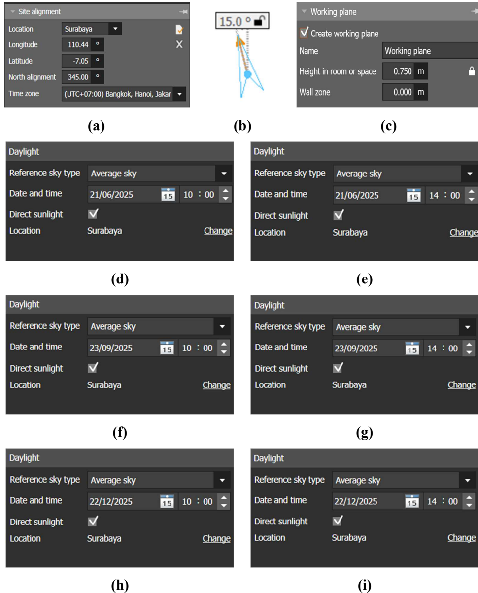
Gambar 4.65 Parameter Simulasi DIALux Pada Rekomendasi Desain 1 (a) Lokasi; (b) Arah Mata Angin; (c) Bidang Ukur (d) 21 Juni, 10.00 WIB; (e) 21 Juni, 14.00 WIB; (f) 23 September, 10.00 WIB; (g) 23 September, 14.00 WIB; (h) 22 Desember, 10.00 WIB; (i) 22 Desember, 14.00 WIB
