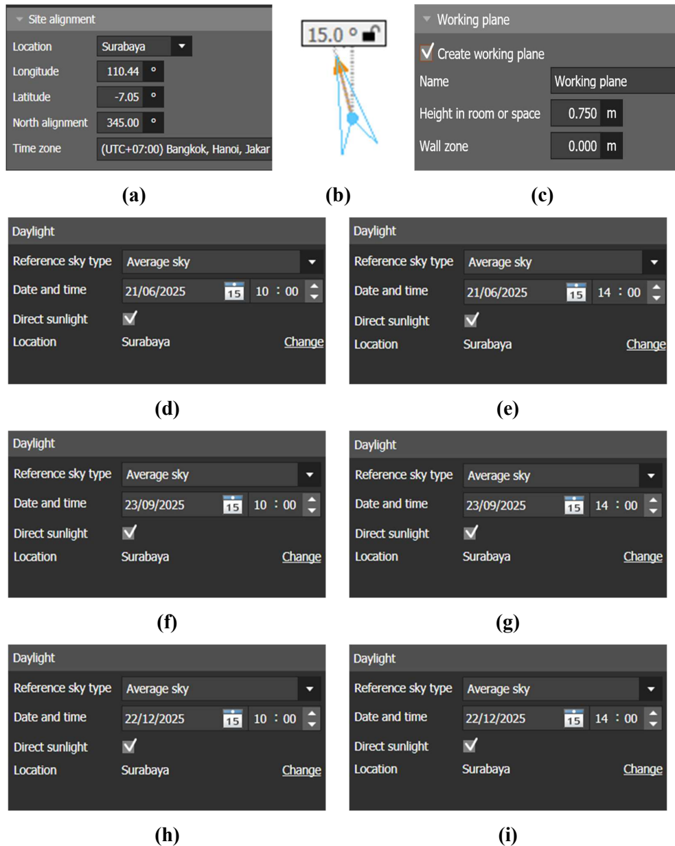
Gambar 4.139 Parameter Simulasi DIALux Pada Rekomendasi Desain 3 (a) Lokasi; (b) Arah Mata Angin; (c) Bidang Ukur (d) 21 Juni, 10.00 WIB; (e) 21 Juni, 14.00 WIB; (f) 23 September, 10.00 WIB; (g) 23 September, 14.00 WIB; (h) 22 Desember, 10.00 WIB; (i) 22 Desember, 14.00 WIB
