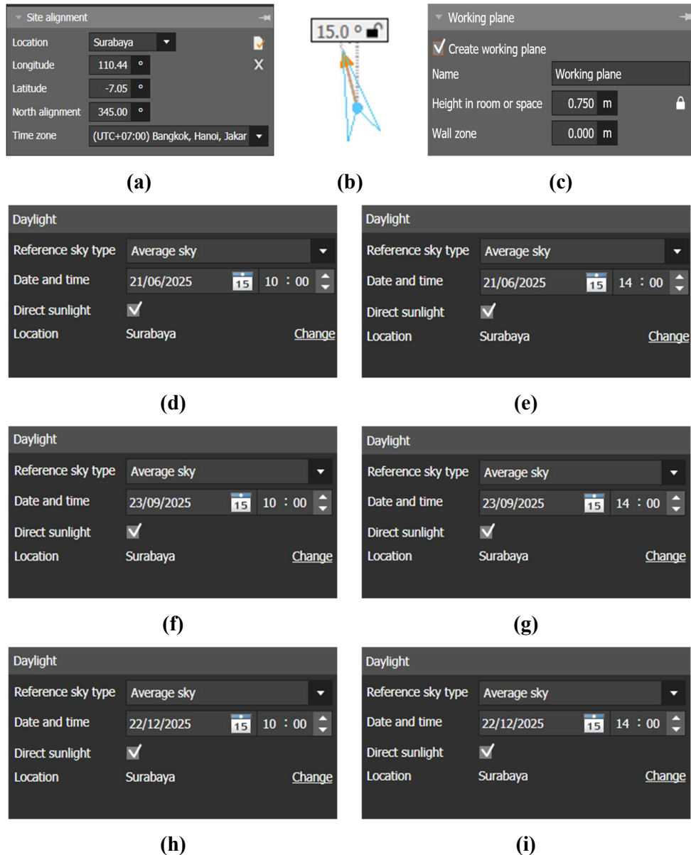
Gambar 4.28 Parameter Simulasi DIALux (a) Lokasi; (b) Arah Mata Angin; (c) Bidang Ukur (d) 21 Juni, 10.00 WIB; (e) 21 Juni, 14.00 WIB; (f) 23 September, 10.00 WIB; (g) 23 September, 14.00 WIB; (h) 22 Desember, 10.00 WIB; (i) 22 Desember, 14.00 WIB
