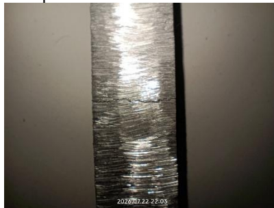
Gambar 4. 26 Visual Retak Spesimen 3 Paduan Aluminium-Kuningan (Sumber: Penulis, 2026)
