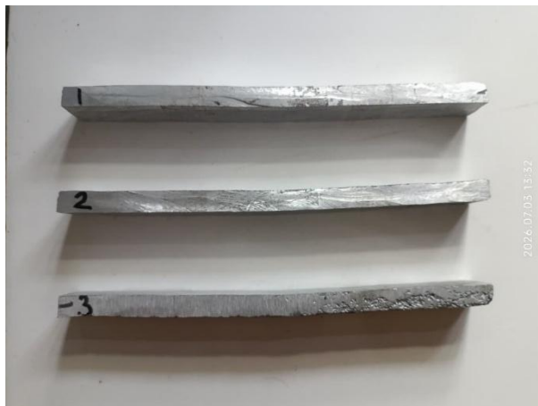
Gambar 4. 20 Spesimen Hasil Uji Bending Komposisi Aluminium 90%-Kuningan 10% (Sumber: Penulis, 2026)
