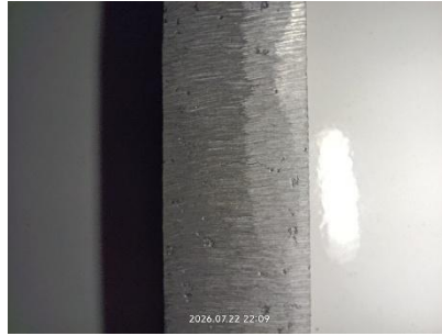
Gambar 4. 31 Visual Retak Spesimen 2 Aluminium Murni (Sumber: Penulis, 2026)
