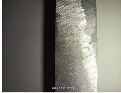
Gambar 4. 29 Visual Retak Spesimen 1 Aluminium Murni (Sumber: Penulis, 2026)
