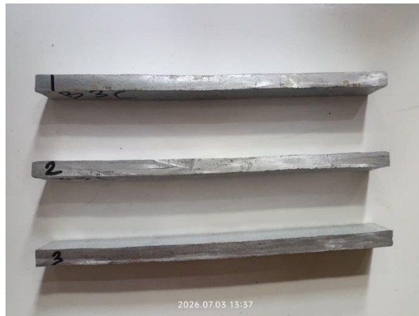
Gambar 4. 27 Spesimen Hasil Uji Bending Komposisi Aluminium 100% (Sumber: Penulis, 2026)
