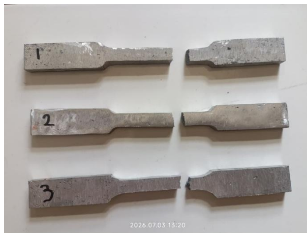
Gambar 4. 3 Spesimen Hasil Uji Tarik Komposisi Aluminium 90% - Kuningan 10% (Sumber: Penulis, 2026)
