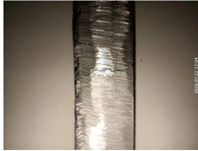
Gambar 4. 22 Visual Retak Spesimen 1 Paduan Aluminium-Kuningan (Sumber: Penulis, 2026)
