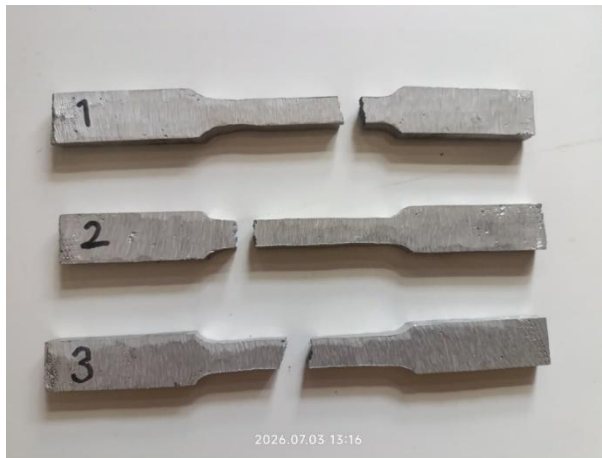
Gambar 4. 10 Spesimen Hasil Uji Tarik Komposisi Aluminium 100% (Sumber: Penulis, 2026)
