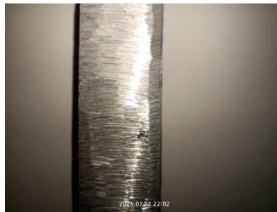
Gambar 4. 24 Visual Retak Spesimen 2 Paduan Aluminium-Kuningan (Sumber: Penulis, 2026)
