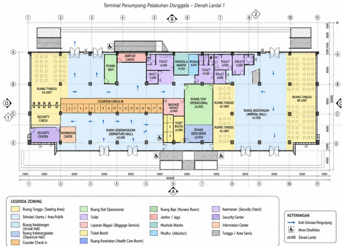
Gambar 5. 6 Zoning Ruang Eksisting Terminal Penumpang Pelabuhan Donggala
