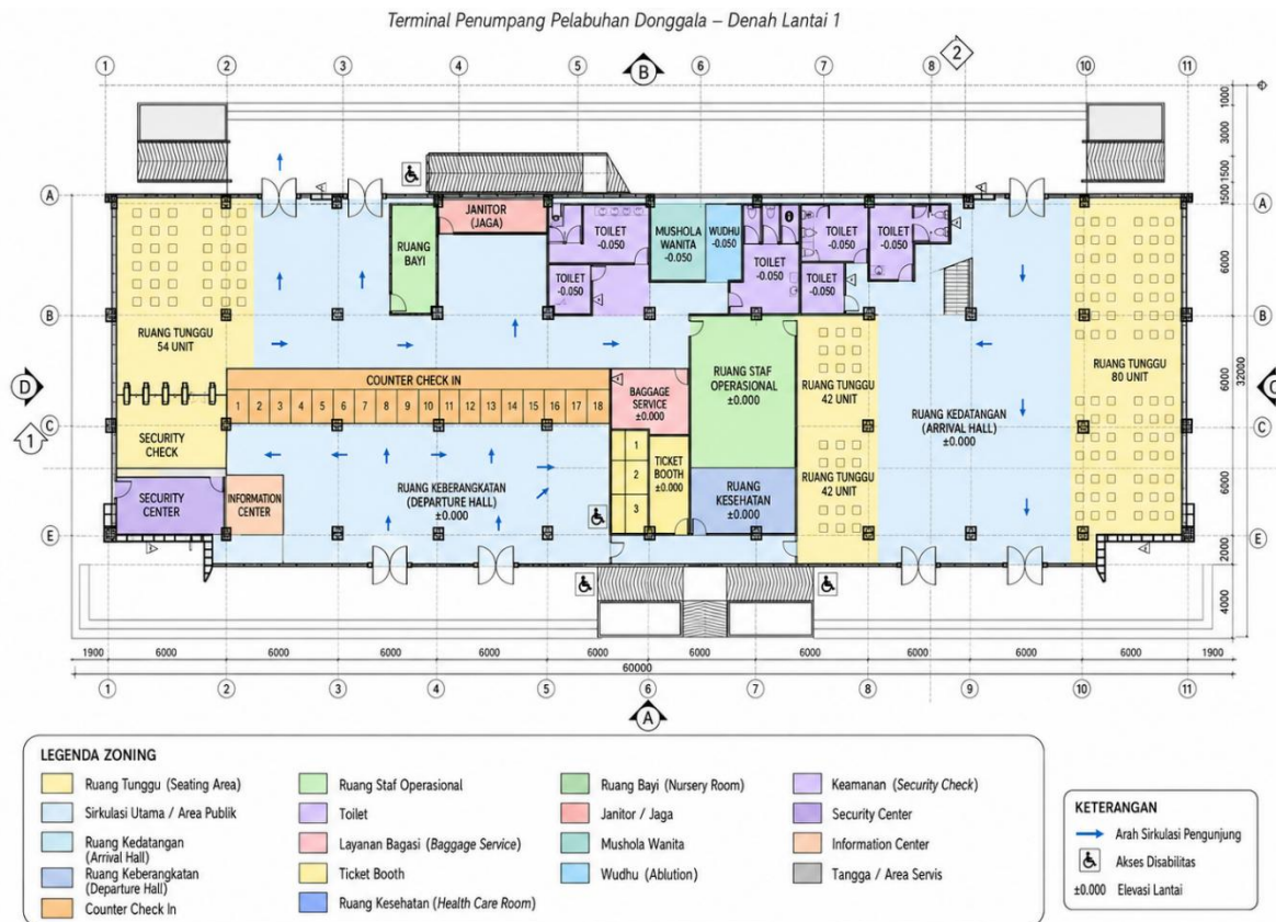
Gambar 5.9 Kondisi Denah Eksisting Lantai 1
