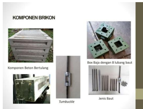
Gambar 2.3 Sistem Prefabrikasi BRIKON Sumber: Google
