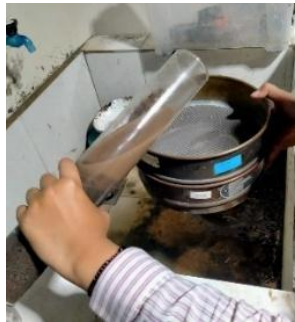
Gambar 3.30. Penuangan Air yang Ada di dalam Gelas Ukur
