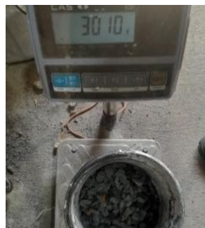
Gambar 3.58. Penimbangan Agregat Kasar Kering Permukaan
