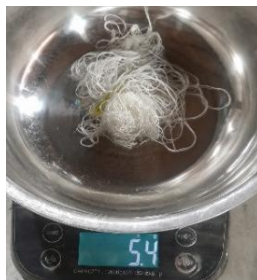
Gambar 3.65. Penimbangan Benang Nilon Basah
