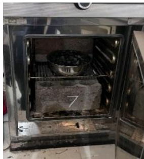
Gambar 3.60. Pengovenan Agregat Kasar Uji Berat Jenis dan Besar Penyerapan Air
