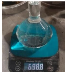
Gambar 3.37. Pengisian Air ke dalam Piknometer
