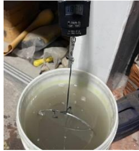
Gambar 3.59. Penimbangan Agregat Kasar di dalam Air
