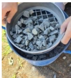
Gambar 3.53. Pengisian Agregat Kasar ke dalam Bejana
