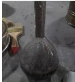
Gambar 3.39. Pengisian Agregat Halus ke dalam Piknometer
