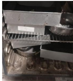
Gambar 3.42. Pengovenan Agregat Halus Uji Berat Jenis
