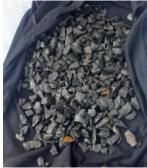
Gambar 3.57. Proses Menghilangkan Air pada Permukaan Agregat Kasar
