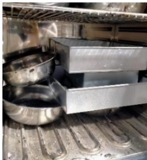
Gambar 3.32. Pengovenan Agregat Halus Kadar Lumpur
