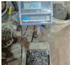
Gambar 3.61. Penimbangan Hasil Kering Oven Agregat Kasar
