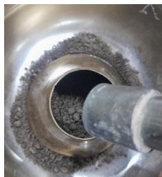
Gambar 3.35. Pemadatan Agregat Halus dengan Batang Penumbuk
