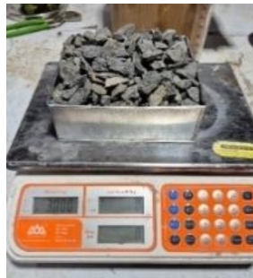
Gambar 3.55. Penyiapan Agregat Kasar untuk Uji Berat Jenis dan Besar Penyerapan Air
