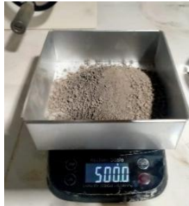
Gambar 3.27. Penyiapan Agregat Halus Kering Oven untuk Uji Kadar Lumpur
