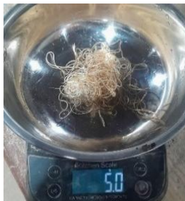
Gambar 3.67. Penimbangan Benang Nilon Kering Oven
