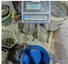
Gambar 3.52. Penimbangan Bejana untuk Pengujian Berat Isi Agregat Kasar
