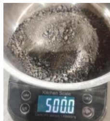
Gambar 3.44. Penyiapan Agregat Halus untuk Pengujian Analisis Saringan
