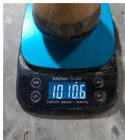
Gambar 3.41. Penimbangan Berat Piknometer, Air, dan Agregat Halus
