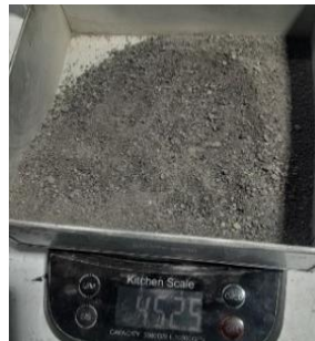
Gambar 3.51. Penimbangan Agregat Kasar Hasil Kadar Lumpur
