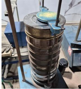
Gambar 3.46. Proses Penyaringan Agregat Halus Menggunakan Sieve Shaker
