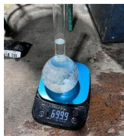
Gambar 3.64. Pengisian Benang Nilon ke dalam Piknometer
