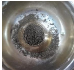
Gambar 3.34. Pengisian Agregat Halus ke dalam Kerucut
