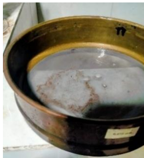
Gambar 3.31. Pemindahan Agregat yang Tertinggal di Saringan ke Wadah
