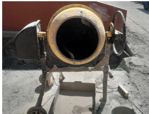
Gambar 3.69. Pengadukan Campuran Beton
