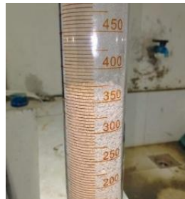
Gambar 3.28. Pengisian Agregat Halus di Gelas Ukur
