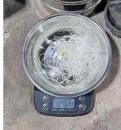
Gambar 3.62. Penyiapan Benang Nilon sebanyak 5 Gram
