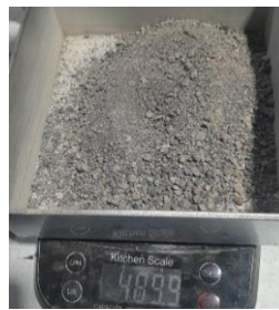
Gambar 3.43. Penimbangan Hasil Oven Berat Jenis Agregat Halus
