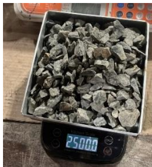
Gambar 3.48. Penyiapan Agregat Kasar Kering Oven untuk Pengujian Kadar Lumpur
