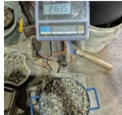
Gambar 3.54. Penimbangan Agregat Kasar dan Bejana
