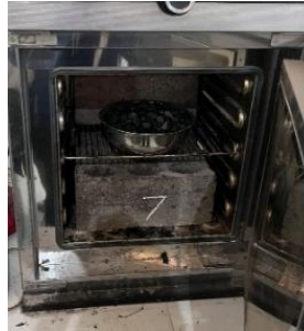
Gambar 3.50. Pengovenan Agregat Kasar Kadar Lumpur
