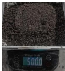
Gambar 3.38. Penyiapan Agregat Halus untuk Uji Berat Jenis dan Besar Penyerapan Air
