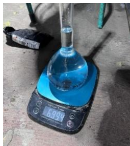
Gambar 3.63. Pengisian Air pada Piknometer dan Penimbangan Beratnya
