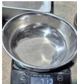
Gambar 3.47. Penimbangan Agregat Halus yang Tertinggal pada Setiap Saringan
