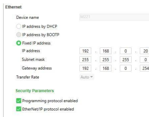
Gambar 4.6 Setting IP address dan Gateway pada SoMachine
