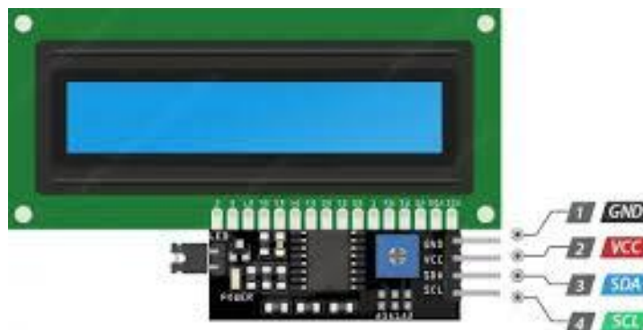
Gambar 2. 17 Gambar dan Pinout LCD I2C
