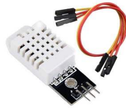
Gambar 2. 14 Sensor DHT22 untuk monitoring kelembapan area [48]
