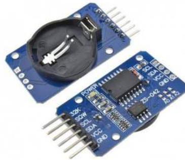
Gambar 2.16 Modul RTC DS3231 untuk pengaturan waktu sistem
