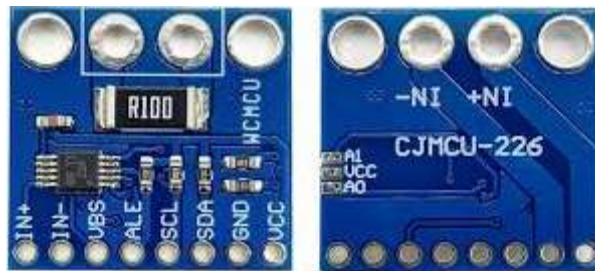
Gambar 2.12 Modul Sensor INA226 untuk pengukuran Arus dan Tegangan DC [47]
