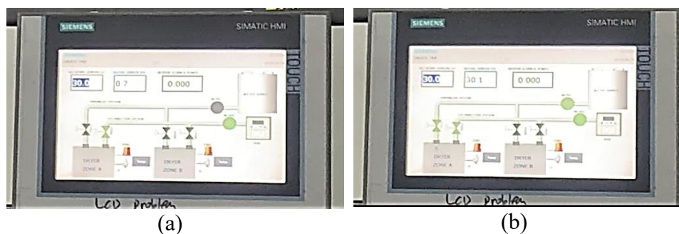
Gambar 4.6. (a) Kondisi awal sistem, dan (b) Pengujian kondisi sistem saat konsentrasi CO mencapai set point .
