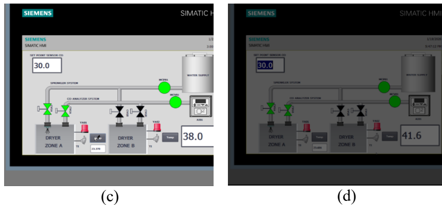
Gambar 4.3. (a) Hasil pengujian pada konsentrasi CO sebesar 31,3 ppm, (b) Hasil pengujian pada konsentrasi CO sebesar 33,5 ppm, (c) Hasil pengujian pada konsentrasi CO sebesar 38,0 ppm, dan (d) Hasil pengujian pada konsentrasi CO sebesar 41,6 ppm.
