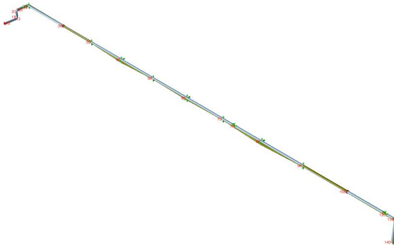
Gambar 4. 2 Kontur Displacement Sistem Perpipaan pada Kondisi Baseline (Sumber: Penulis, 2026)
