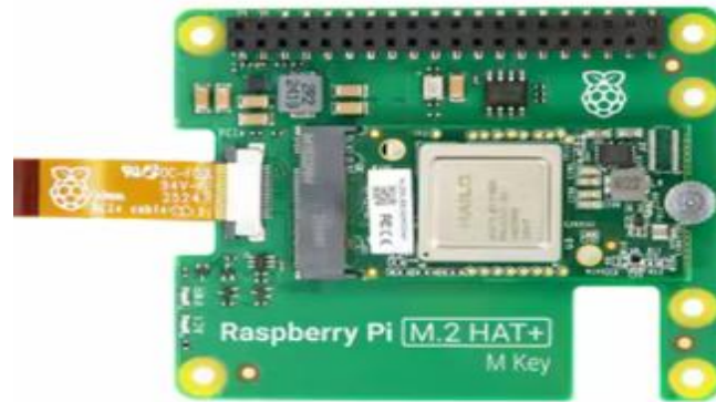
Gambar 2. 11 Bentuk Fisik Hailo-8L
