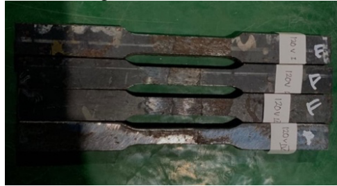
Gambar 4. 1 Spesimen Uji Tarik
