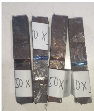
Gambar 4. 2 Gambar Spesimen Pengujian Impak
