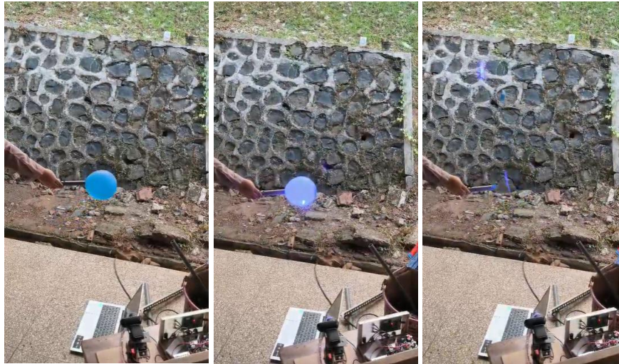
Gambar 4.6 Aktivasi Laser saat Objek Terdeteksi Diam
