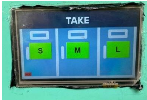
Gambar 4. 12 Tampilan mode TAKE ketika seluruh loker dalam kondisi kosong (tombol berwarna hijau dan tidak dapat dipilih).
