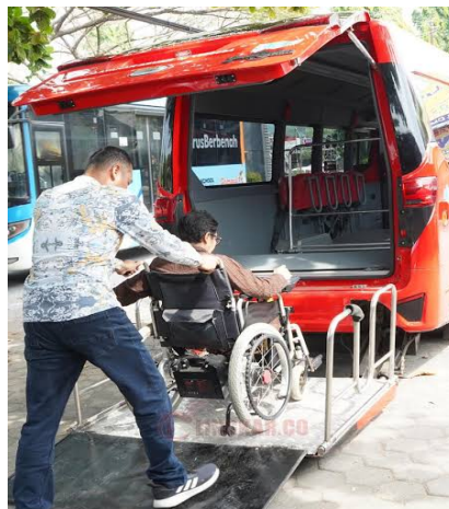
Gambar 2. 12 Mikrobus Khusus Disabilitas Trans Semarang dengan Fasilitas Kursi Roda dan Sistem Hidrolis
