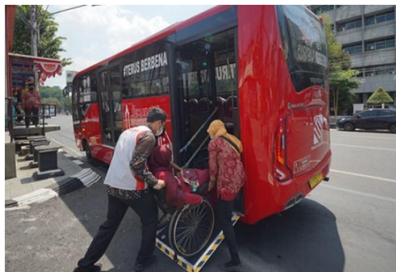
Gambar 2. 14 Bus Low Entry Trans Semarang Dilengkapi Ramp dan Ruang Khusus Kursi Roda Untuk Pengguna Disabilitas
