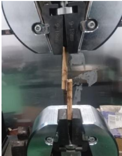
Gambar 4.5 Pengujian Spesimen Uji Geser dengan UTM (Sumber: Dokumen Pribadi, 2026)
