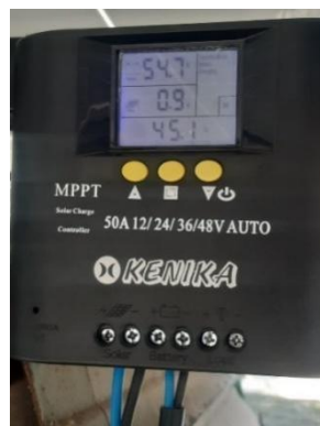
Gambar 3.16 Pengukuran nilai arus yang mengalir ke akumulator
