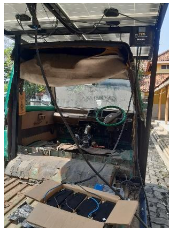
Gambar 3.10 Pemasangan kabel output dari solar charger controller ke beban (akumulator)
