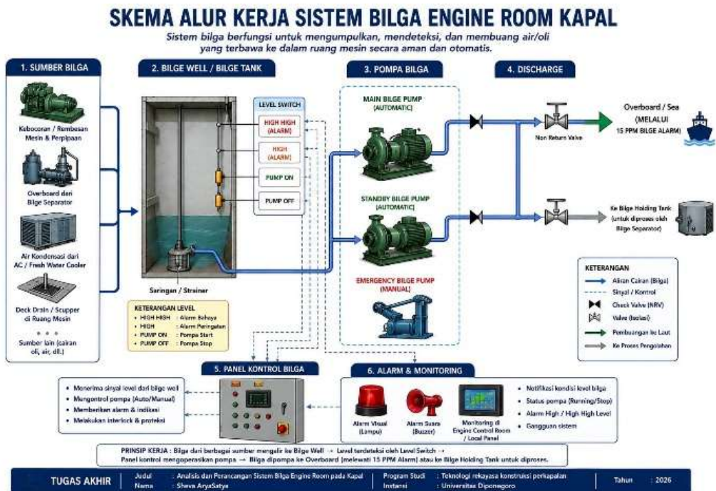
Gambar 4. 1 Diagram Skema Sistem Bilga Engine Room (Sumber : Penulis, 2026)
