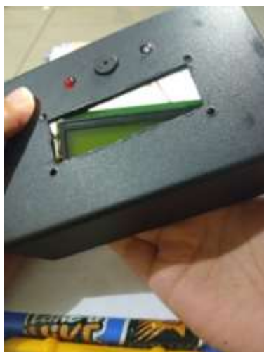
Gambar 4.8. Proses Pemasangan Komponen ke Lubang
