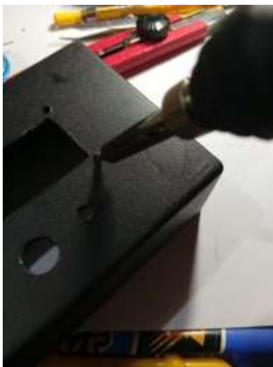
Gambar 4.5. Proses Pelubangan Box Alat
