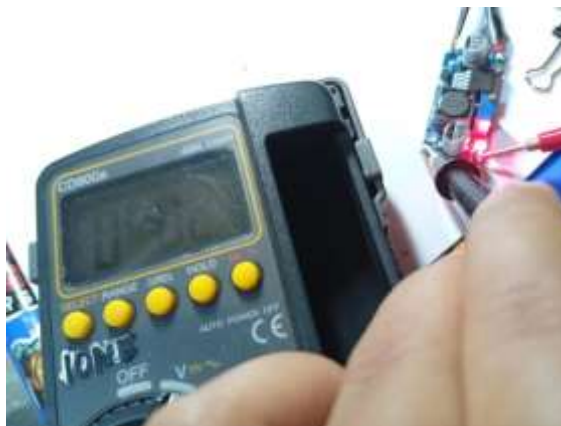
Gambar 4.7. Proses Pengukuran Output LM2596
