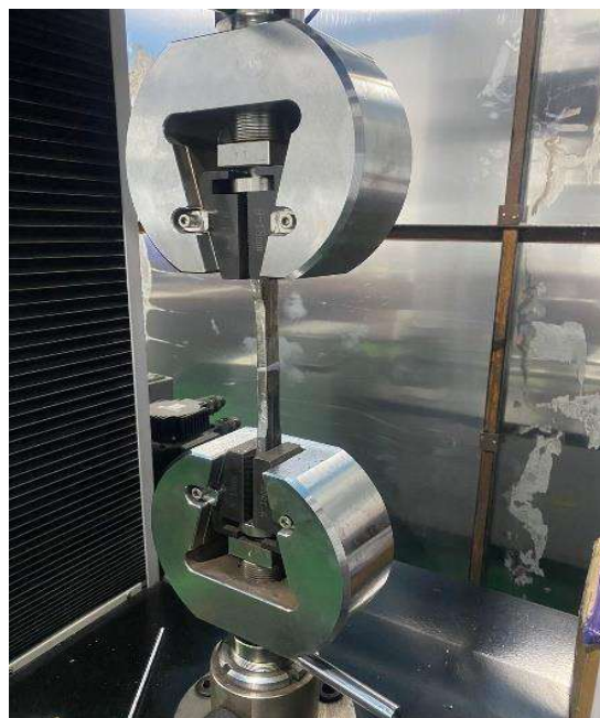
Gambar 4. 18 Proses Uji Tarik Menggunakan Alat Uji Tarik
