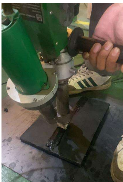
Gambar 4. 12 Proses Pengelasan Filler
