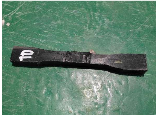
Gambar 4. 15 Spesimen Dilas dan Tanpa Pemanasan
