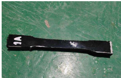
Gambar 4. 13 Spesimen Tanpa Pengelasan dan Tanpa Pemanasan
