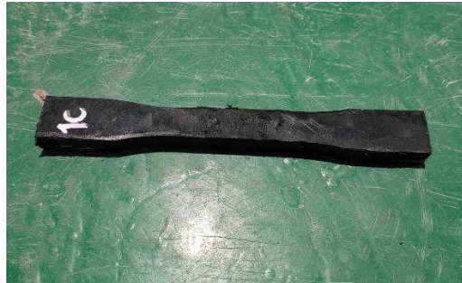
Gambar 4. 16 Spesimen Dilas dengan Pemanasan
