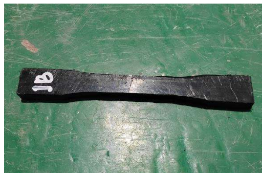
Gambar 4. 14 Spesimen Tanpa Pengelasan dengan Pemanasan
