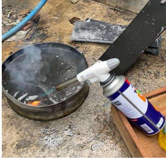
Gambar 4. 7 Proses Pemanasan Oli
