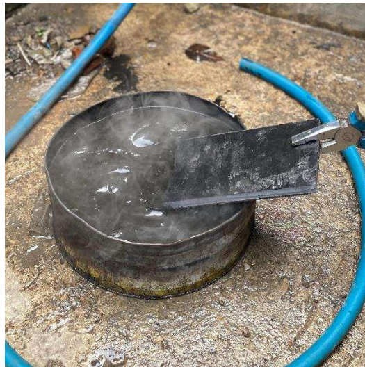
Gambar 4. 8 Proses Pemanasan HDPE
