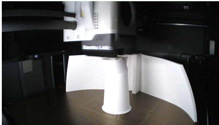
Gambar 4. 60 Proses Pembuatan Prototype Menggunakan 3D Print
