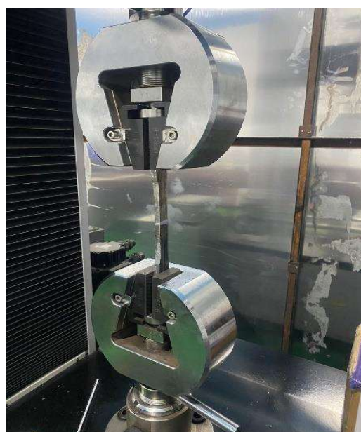
Gambar 4. 18 Proses Uji Tarik Menggunakan Alat Uji Tarik
