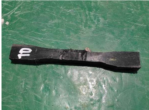
Gambar 4. 15 Spesimen Dilas dan Tanpa Pemanasan
