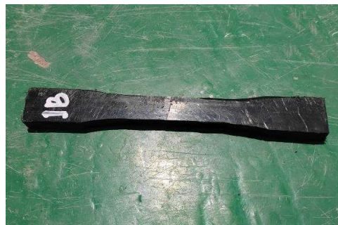
Gambar 4. 14 Spesimen Tanpa Pengelasan dengan Pemanasan
