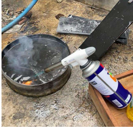
Gambar 4. 7 Proses Pemanasan Oli
