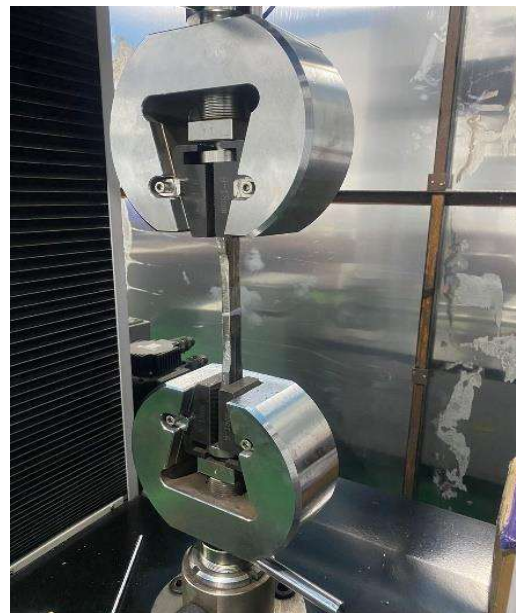
Gambar 4. 18 Proses Uji Tarik Menggunakan Alat Uji Tarik
