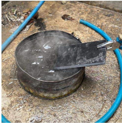
Gambar 4. 8 Proses Pemanasan HDPE
