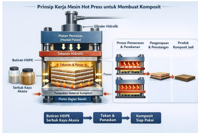
Gambar 2. 8 Prinsip kerja mesin hot press
