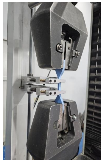
Gambar 4.10 Pemasangan alat extensometer
