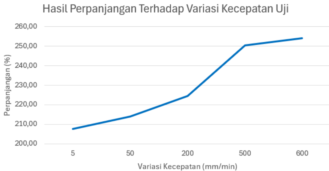
Gambar 4.14 Grafik perbandingan hasil perpanjangan terhadap variasi kecepatan uji
