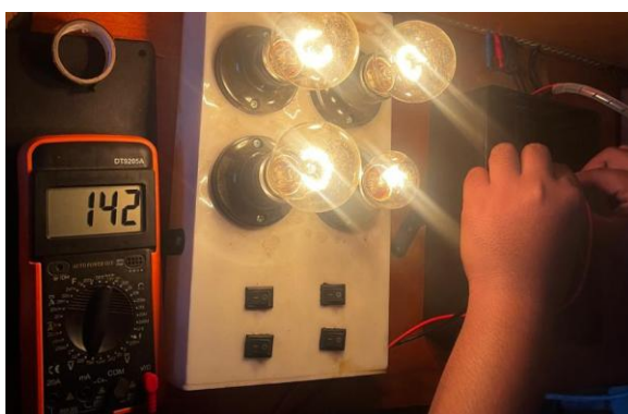
Gambar 4. 7 Pengukuran Tegangan Saat Beban 35 W Aktif
