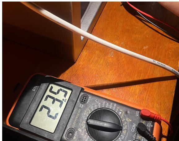
Gambar 4. 5 Pengukuran Input Tegangan BTS7960
