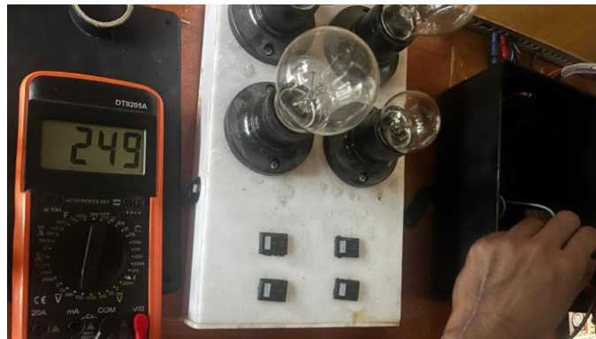
Gambar 4. 4 Data Pada Output Trafo Dengan Multimeter
