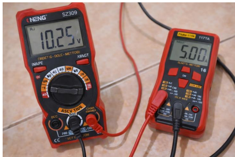
(b) Pengujian menghitung V dan A pada motor power window
