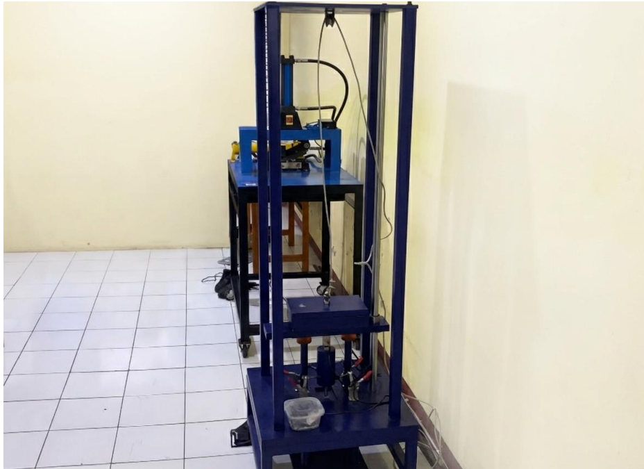
Gambar 4.1 Hasil fabrikasi drop test machine
