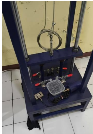
Gambar 3.24 Integrasi load cell type S pada alat uji
