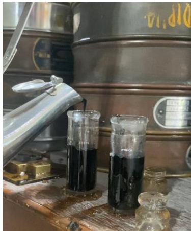
Gambar 3. 12 Pengujian Berat Jenis Aspal Sumber : Dokumentasi Pribadi
