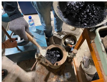
Gambar 3. 16 Pemindahan Agregat Ke Dalam Cetakan Sumber : Dokumentasi Pribadi
