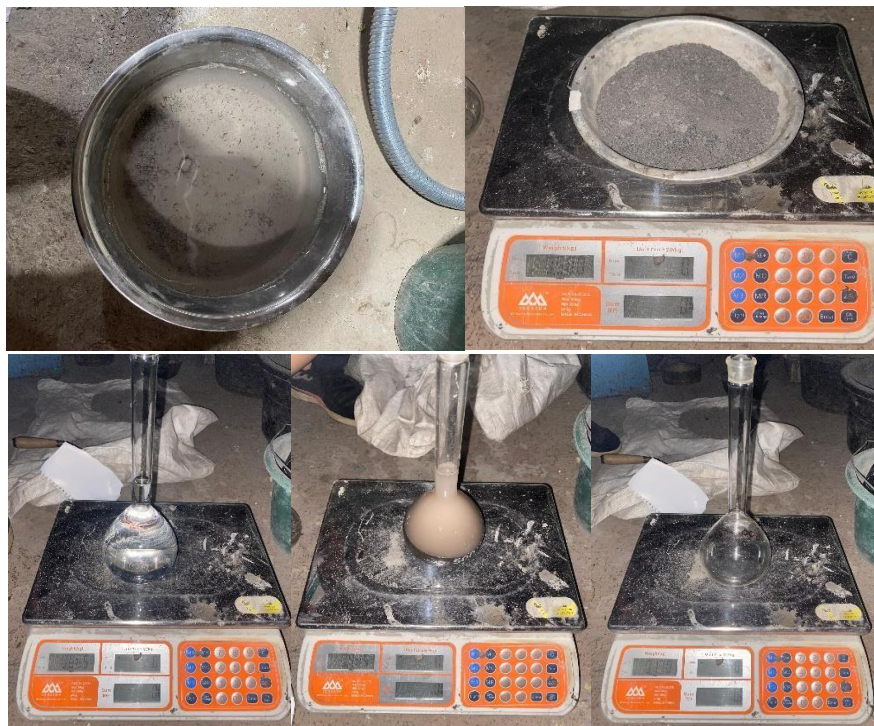
Gambar 3. 7 Pengujian Berat Jenis dan Penyerapan
