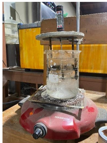
Gambar 3. 11 Pengujian Titik Lembek Sumber : Dokumentasi Pribadi
