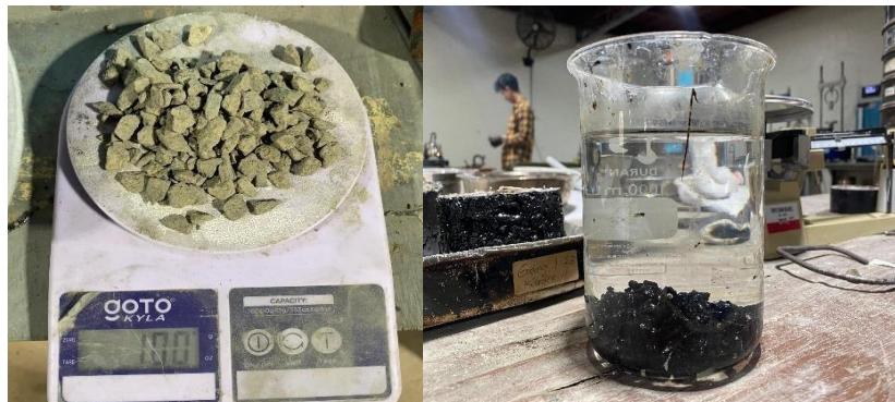
Gambar 3. 5 Pengujian Kelekatan Agregat Terhadap Aspal
