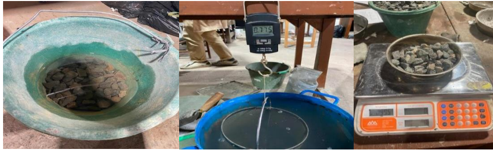
Gambar 3. 3 Pengujian Analisis Saringan dan Penyerapan
