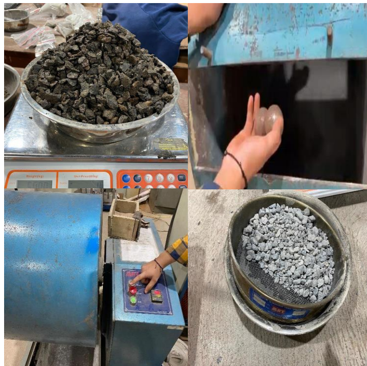
Gambar 3. 4 Pengujian Los Angeles Abrasion Test
