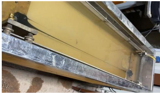
Gambar 3. 10 Pengujian Daktilitas Aspal Konvensional Sumber : Dokumentasi Pribadi
