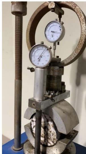
Gambar 3. 18 Pengujian Marshall Sumber : Dokumentasi Pribadi
