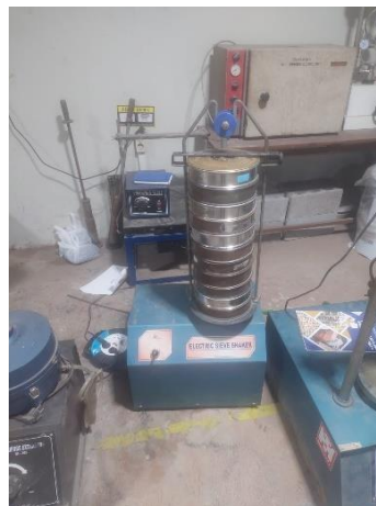
Gambar 3. 2 Pengujian Analisis Saringan Agregat Kasar
