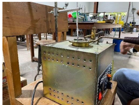
Gambar 3. 13 Pengujian Titik Nyala dan Titik Bakar Sumber : Dokumentasi Pribadi
