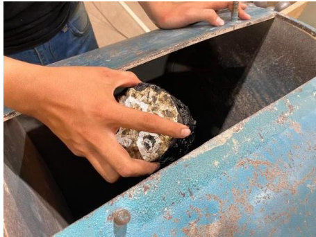
Gambar 3. 19 Pengujian Cantabro Sumber : Dokumentasi Pribadi
