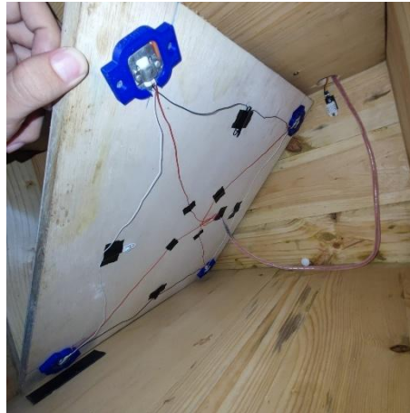
Gambar 4. 11 Pemasangan Sistem Timbangan
