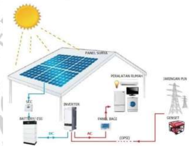
Gambar 2.3 Ilustrasi Pembangkit Listrik Tenaga Surya Jenis Off-Grid (Sumber: Sunergi, 2022)
