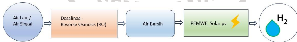
Gambar 2. 7 Suplai air bersih desalinasi teknologi Reverse Osmosis
