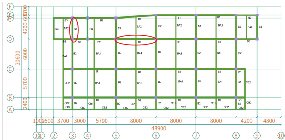
Gambar 4. 1 Denah Perencanaan Balok Lantai 2
