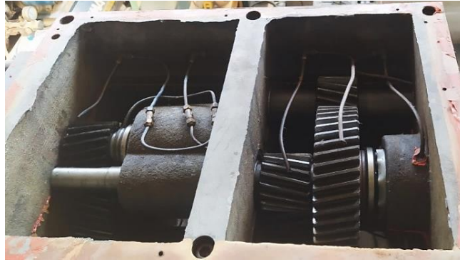
Gambar 2.7 Susunan roda gigi, dan poros gearbox
