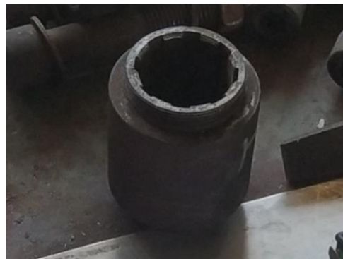
Gambar 2.16 Pengunci sambungan poros
