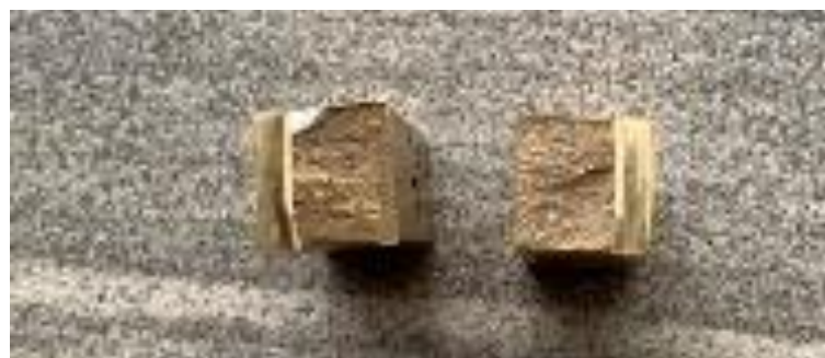
Gambar 4. 14 Patahan kuningan tampak depan
