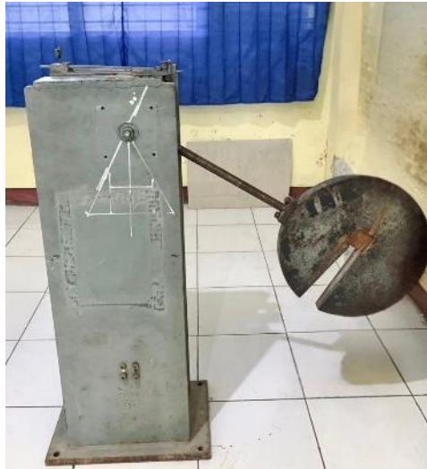
Gambar 4. 1 Alat impact sebelum di modifikasi
