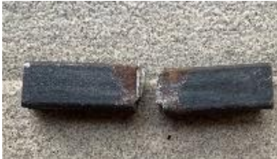
Gambar 4. 4 Patahan baja ST-37 tampak atas
