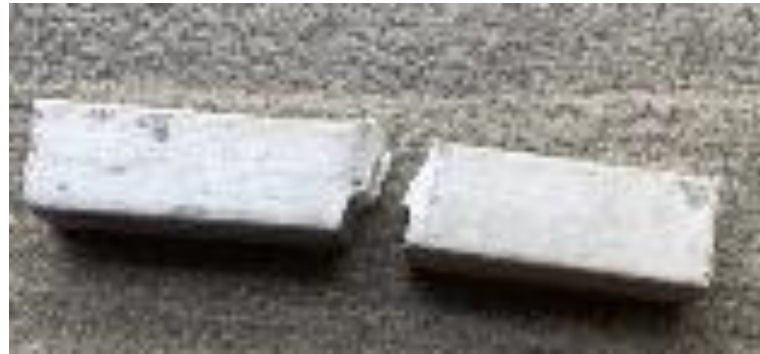
Gambar 4. 10 Patahan alumunium tampak atas
