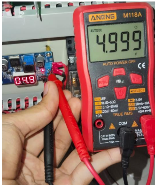
Gambar 4. 3 Pengukuran presisi tegangan keluaran Stepdown LM2596
