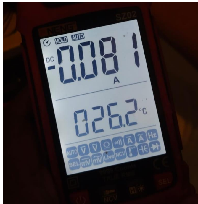
Gambar 4. 18 Pengukuran Arus Dosing Pump dengan Beban
