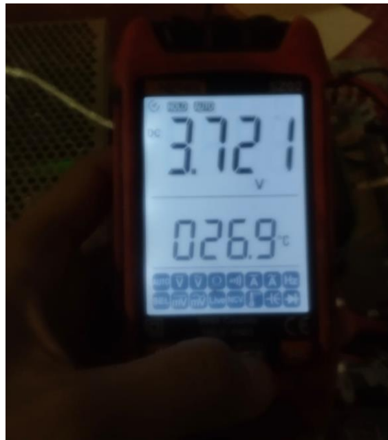
Gambar 4. 8 Pengukuran Tegangan Titik Nol
