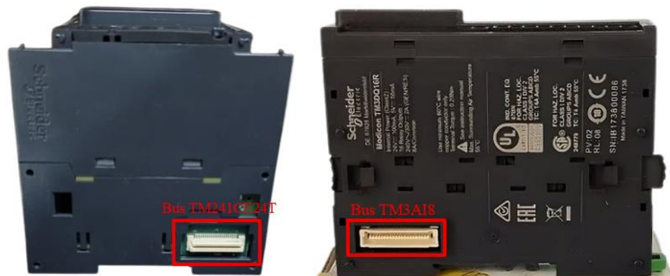
Gambar 4.2 Koneksi Bus I/O Paralel PLC TM241CE24T dan Modul TM3AI8
