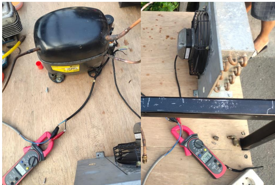
Gambar 4.13 Proses Pengukuran Arus Kompresor dan Fan Kondensor
