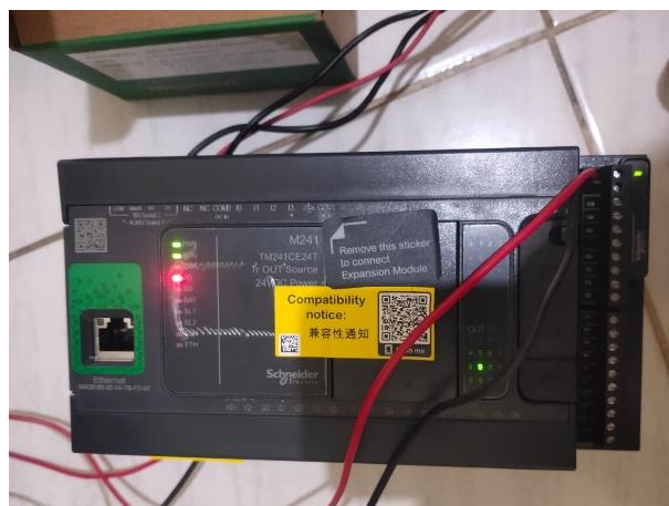
Gambar 4.3 Pengujian Koneksi Perangkat PLC TM241CE24T dan Modul TM3AI8
