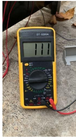
Gambar 4. 11 Proses pengukuran tegangan
