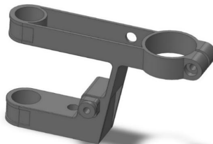
Gambar 3. 4 Desain penyangga barrel
