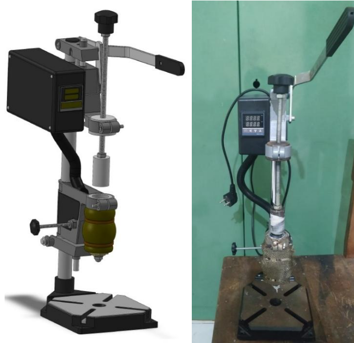
Gambar 4. 1 Desain konsep dan hasil pembuatan mesin injeksi molding
