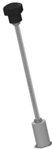
Gambar 3. 10 Desain plunger (batang penekan)
