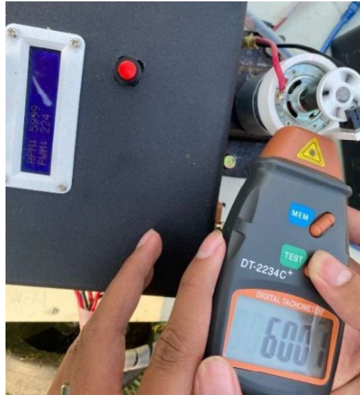
Gambar 4.7 Pengujian RPM Motor Pemotong Ketika Pakai Logika Fuzzy
