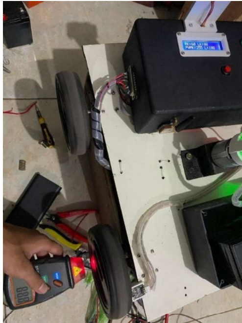
Gambar 4.5 Hasil Pembacaan Kecepatan Pada LCD dan Tachometer
