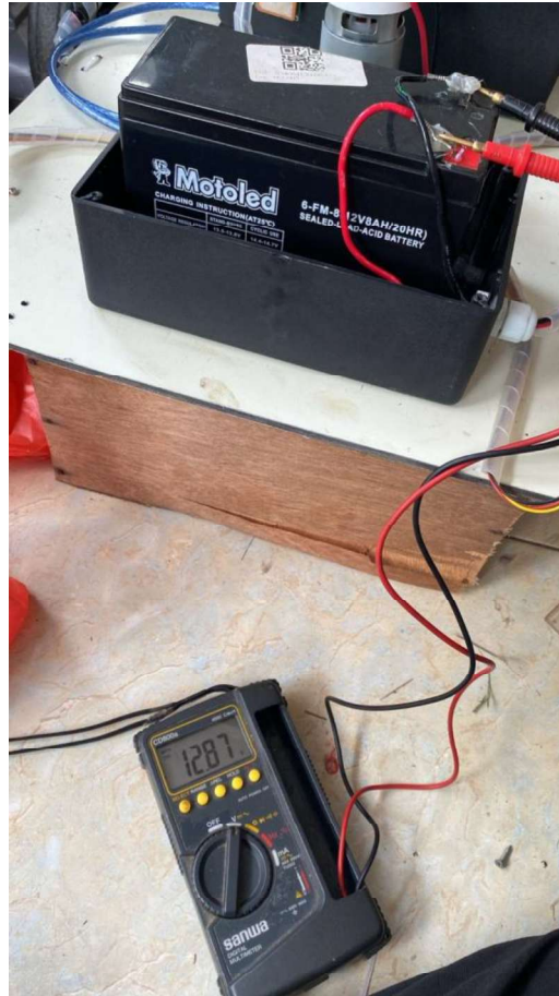
Gambar 4. 9 Pengujian Tegangan Baterai
